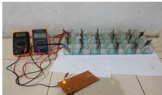
Gambar 3: Rangkaian secara keseluruhan yang terdiri dari (a) elektroda negatif, (b) elektroda positif, (c) larutan asam, (d) jembatan Garam, (e) multimeter, (f) penjepit buaya dan (g) LED.
